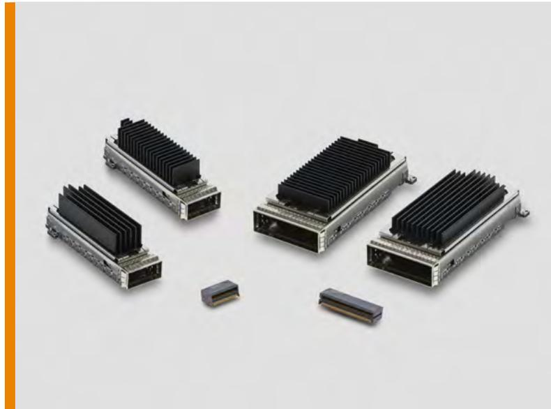
TE Connectivity (TE) は、高速通信向けに設計された新しい CFP プラグブル I/O コネクタをリリース致します。CFP2 と CFP4 は、高密度 0.6mm コンタクトピッチ、100Gbps 以上のイーサネット（およびその他のプロトコル）接続において、レーン当たり 28Gbps を達成。これは CFP 既存製品の 2.8 倍の速さに相当します。さらに、優れたシグナルインテグリティと、競合製品よりも堅牢なソリューションを提供する高耐久性のケージ構造により、信頼性の高い接続を実現します。TE は CFP2 および CFP4 の最大級の品揃えで、お客様のニーズに応えるフレキシブルな設計オプションを多数ご用意しています。
