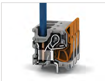
単線またはフェール圧着電線は差し込むだけのプッシュ・イン結線
