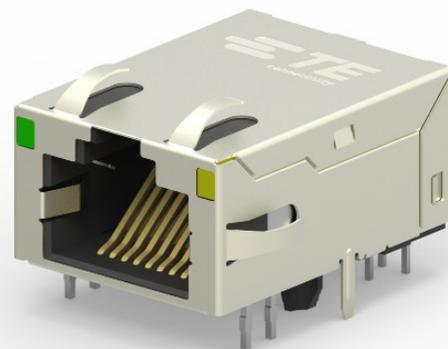
トランス内臓型 RJ45 ジャックは、インダストリアルイーサネット向けにケーブルから物理層までが高度なコネクティビティソリューションを提供します。トランスをジャックの内部に一体化することにより、EMI ノイズシールドが大幅に改善され、接続の信頼性が向上します。1 × 1 ストレートおよび、ライトアングル、1 × 2、2 × 1 の標準化されたラインナップで産業用アプリケーションの多くに対応しますので、ソリューションをこの中からお探しする事が可能です。高い信頼性、耐食性、広い温度範囲、長い製品寿命など、産業機器に求められる要求事項を広く満たしています（最新のリフロー生産工程のサポートを含む）。
