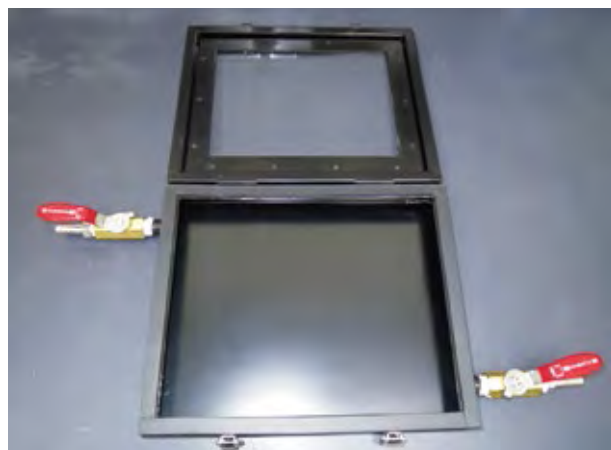
当社簡易窒素置換設備
