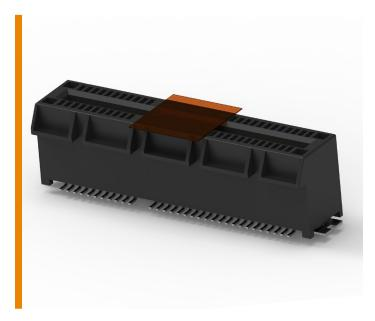
TE Connectivity (TE)の PCIe Gen 4 カード エッジコネクタは、標準化団体 PCI-SIG の Card Electromechanical (CEM) 仕様 4.0 に適合し、Intel および AMD の帯域幅最大 16 Gbps を備えた次世代プラッ トフォームをサポートします。TE の PCIe Gen4 カード エッジコネクタは、優れたシステム アプリケーションであるス ケーリング向けに次世代 CPUをサポートするために設計されており、1.00mm ピッチ を特徴とします。 その1.00mm ピッチがPCI Express のシグナリング設計の全世代を可能にし、16Gbps (PCIe Gen 4)、8.0 Gbps (PCIe Gen 3)、5.0 Gbps (PCIe Gen 2) および 2.5 Gbps (PCIe Gen 1) の速度をサポートします。 さらに、PCIe Gen 4 カード エッジ コネクタのフットプリントと嵌合インターフェースは、PCle の各世代と下位互換性があります。
