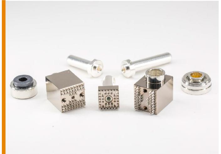
TE Connectivity (TE) の新しい ICCON ブロックと ICCON インサートハイパワーピンおよびソケット製品は、最大 350A のアプリケーション向けに柔軟なデザインフレキシビリティを提供します。ICCON インサート製品にはオプションのフローティング機能があり、2枚のPCB基板間または、バスバーを嵌合する際、 $\pm 1\text{mm}$  の中心のズレを許容し、スムーズな取り付けが可能です。本製品は、あらゆるサイズに対応し、実績のある TE の CROWN BAND プラスソケットと同様の設計コンセプトを使用しており、接触抵抗と電力損失を低減できます。
