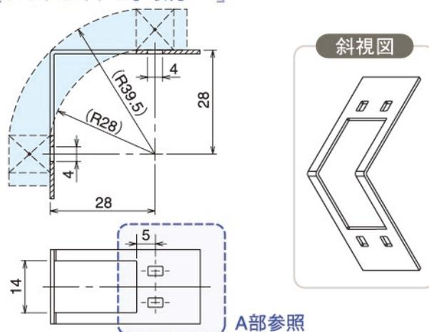
インサイドL字取付 \*1、アウトサイドL字取付 \*2 では中央の挿入部は浮いた状態となります。
