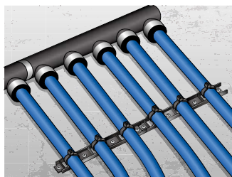
水道、ガスホースなどの配管固定
