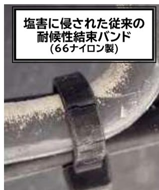
11ナイロン製で、耐候性・耐塩害性・耐薬品性に優れています。塩化カルシウムや塩化亜鉛などの腐食生成物に侵されることなく、長期間、結束力を維持します。
