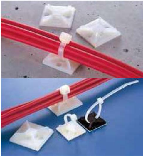
マウントベースはインシュロックタイを併用し、パネル面に貼り付けるだけで配線を固定することができる固定具です。マウントベースの粘着テープは、クッション性の良い発泡体に、アクリル系、あるいは合成樹脂の粘着剤を組み合わせた、両面粘着テープです。タイル、ガラス、金属、鋼板、ABS樹脂製品への接着性能が特に優れています。
