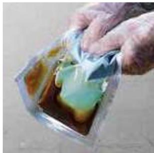
注入前のレジンは二色に分かれており、薄青色のレジンがオレンジ色の硬化剤と混ざることによって緑色に変化し、目視でしっかりと混ぜ合わせることが確認できるため、混合不足による硬化不良を防止します。
