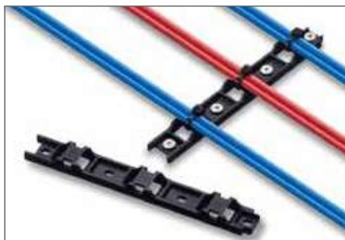
マウンティングプレートは、50mmの等間隔で固定することが可能な配線固定具です。連結させることができるため、等間隔を連続して維持させることができます。M4サイズのビス、木ネジ、コンクリートビスなどでしっかりと固定することができます。インシュロックタイを併用して電気、水道、空調などの様々な配線・配管、機械配線をしっかりと固定することができます。
