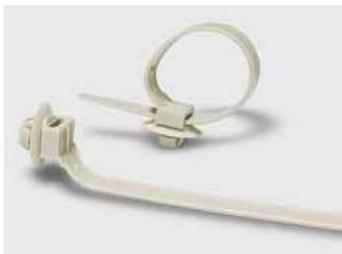
PF管支持用省スペースプッシュマウントタイは、電路支持金具の取付穴に差し込むだけで、PF管を固定することができるインシュロックタイです。プッシュマウントの矢じりは、ラジオペンチなどで取り外すことが可能です\*。また、バンド部はマイナスドライバーなどでロックを解除することができます\*。PF管呼び径 16、22、28 の幅広いPF管サイズに対応します。
