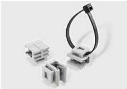
エッジクリップは、パネルエッジにはめ込むだけで簡単に配線を結束・固定することができる配線固定具です。山形鋼、リップ溝形鋼などの建築鋼材やケーブルラック、電路支持材のアンクル、チャンネルなどのエッジにはめ込んで使用します。インシュロックタイを併用するため、1本~複数本のケーブルのほか、PF管なども固定することが可能です。独自のハウジング形状と爪クランプ機構を採用し、鋼材のエッジにガッチリと食い込み、強固に固定します。
