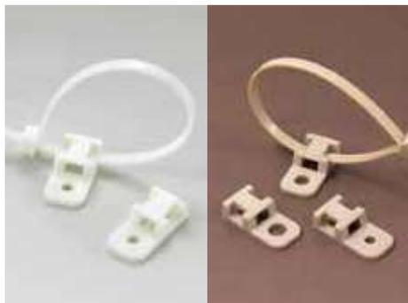
アンカーマウントは、タイを縦方向、横方向のいずれからも結束可能なビス止め固定具です。66ナイロンのほかに、耐薬品性に優れたふっ素樹脂、240℃までの超耐熱性を持つ PEEK、電導性材料を加えたポリプロピレンなど幅広い材質の種類を持ち、様々な環境に対応します。
