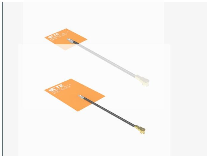
TE Connectivity (TE) の接着剤マウント超広帯域(UWB)アンテナは、セラミックチップアンテナに代わる独立した超薄型グランドプレーンを提供し、アンテナをデバイスの筐体の実装することで設計の柔軟性を向上させます。本製品は、屋内での正確な位置決めや追跡アプリケーション、アクセスコントロール、コンタクトトレースなどを可能にします。UWBアンテナは、10cm以内の物体の位置を特定し、機器の筐体に取り付けることができるため、ローバンドおよびハイバンドのUWBチャンネル1~9(3~8.5GHz)用の小型パッケージでパワフルなソリューションを提供します。
