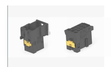
TE Connectivity (TE) のMCPハイブリッド同軸コネクタは、既存の非防水MCPコネクタを利用して、最大9 GHzの同軸データライン(9信号)と電源ライン (MCON 1.2 CB端子使用)を提供し、トラックやバス車内への高解像度カメラの実装を可能にします。
