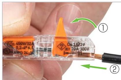
① レバーを真上まで引き上げてむき出した電線を突き当たるまで差し込みます。
