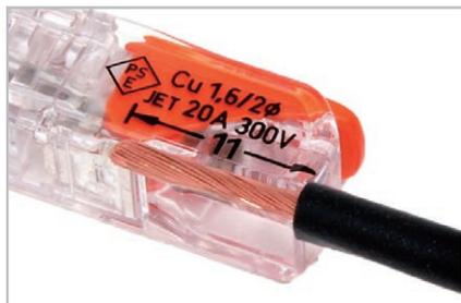
電線の被覆を **10 ~ 12mm** むいてください。ストリップゲージで長さを確認してください。
