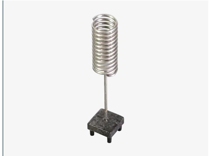
2.4GHz垂直ヘリカルアンテナは、Bluetooth®やZigBee®などの2.4GHz ISM周波数帯アプリケーション向けに設計されたコンパクトな表面実装ヘリカルアンテナです。2.4GHz垂直ヘリカルアンテナは、直径0.6mmのニッケルめっき高炭素鋼から作られており、堅牢でコンパクトな無指向性内臓アンテナを必要とする基板取り付けに使用できます。アンテナのネクタスタイルのベースは、量産で均一な性能を発揮するための適切な取り付けを保証します。
