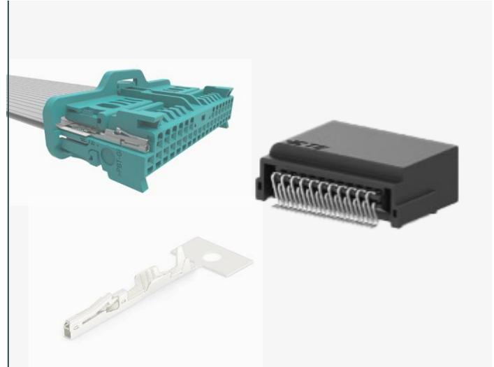
TE ConnectivityのMQSコネクタに基づき、より小型化されたNano MQSコネクタは、端子が完全に挿入されるとプラスチック・ハウジングに音と感触でラッチされるロッキングランス端子設計を備えた製品です。Nano MQSコネクタのピッチは1.8mmで、基板実装面積を最大50%削減できる一方、電流容量は最大6Aで、最大動作温度は170°C (AG)です。
