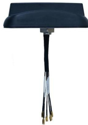
GARマルチポート車載アンテナは、公共安全、運輸、アフターマーケット・フリート・アプリケーションに優れたソリューションを提供します。3G / 4G / 5G / ISM / CBRS帯域での2ポートMIMO動作と、低/高周波数Wi-Fi帯域での2ポートMIMO動作用に構成され、GNSS用に第5のポートがさらに追加されています。QMAコネクタを搭載し、迅速な取り付けが可能です。
