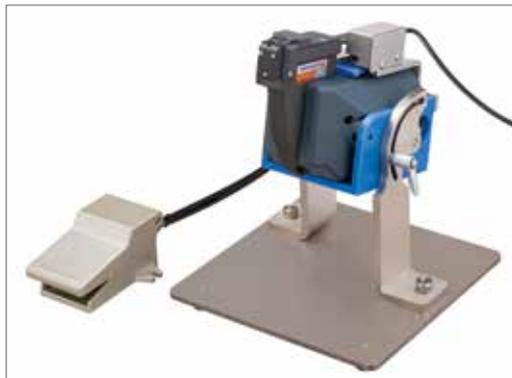
メタルタイ用エアースト式結束工具専用のベンチマウントシステムです。フットペダルで操作を行うため、両手を使って結束作業ができます。
